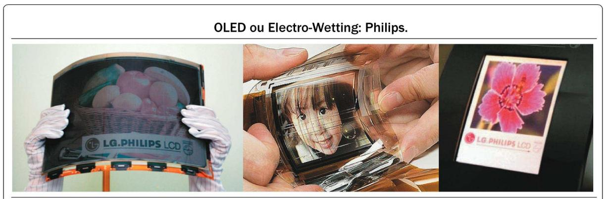
Figura 11 - Electro-Wetting, solução em e-paper da Philips e LG. Apresenta, respectivamente, a maleabilidade e flexibilidade do terminal, a composição da imagem, e por fim, um detalhe do produto LG Philips LCD (PHILIPS, 2008).
