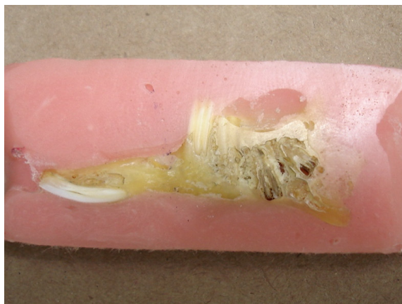
Figura 18: Amostra incluída em resina acrílica após lixamento e polimento.
