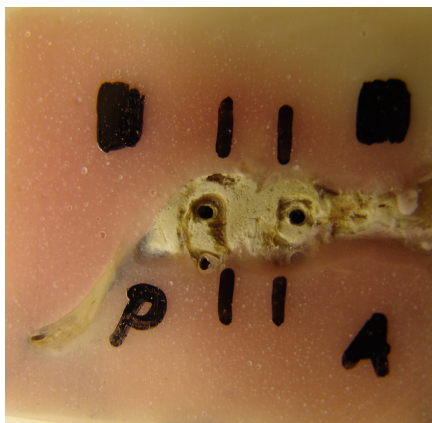
Figura 20: Mandíbula de coelho incluída em resina. Após lixada e polida, foi marcada a região de interesse para os testes físicos.
