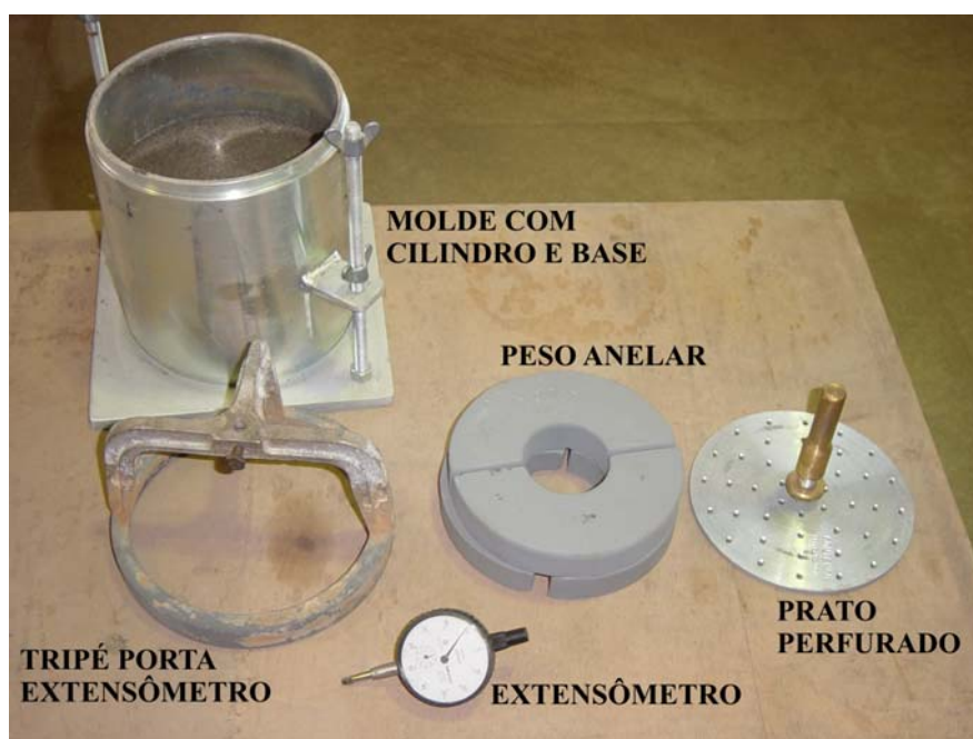
Figura 3.17 - Aparelhagem necessária para se fazer a leitura da expansão
