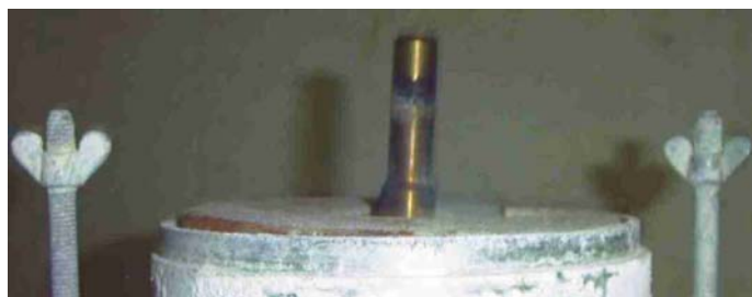
Figura 4.20 - Inclinação da haste do prato perfurado no topo do corpo-de-prova 17 (CP 17) durante o ensaio de expansão da amostra tratada 1 pelo método PTM-130/78, energia do Proctor normal
