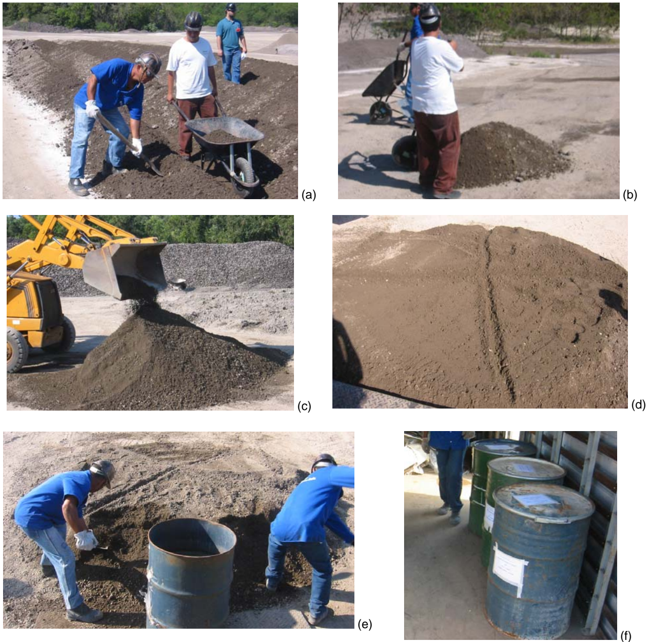
Figura 3.8 - Etapas da amostragem da escória de aciaria LD tratada 1 e tratada 2: (a) retirada da amostra parcial; (b) formação da pilha cônica através das amostras parciais; (c) homogeneização e formação da pilha cônica; (d) quarteamento da pilha tronco-cônica; (e) retirada das partes opostas para colocação nos tonéis; (f) tonéis lacrados e identificados para serem enviados à UFES
