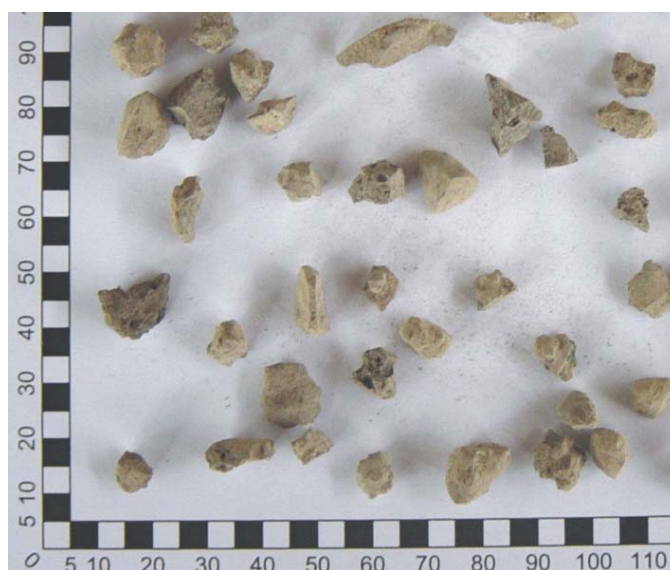
Figura 4.3 - Exemplo da avaliação da angulosidade da escória de aciaria LD estudada, escala em milímetros
