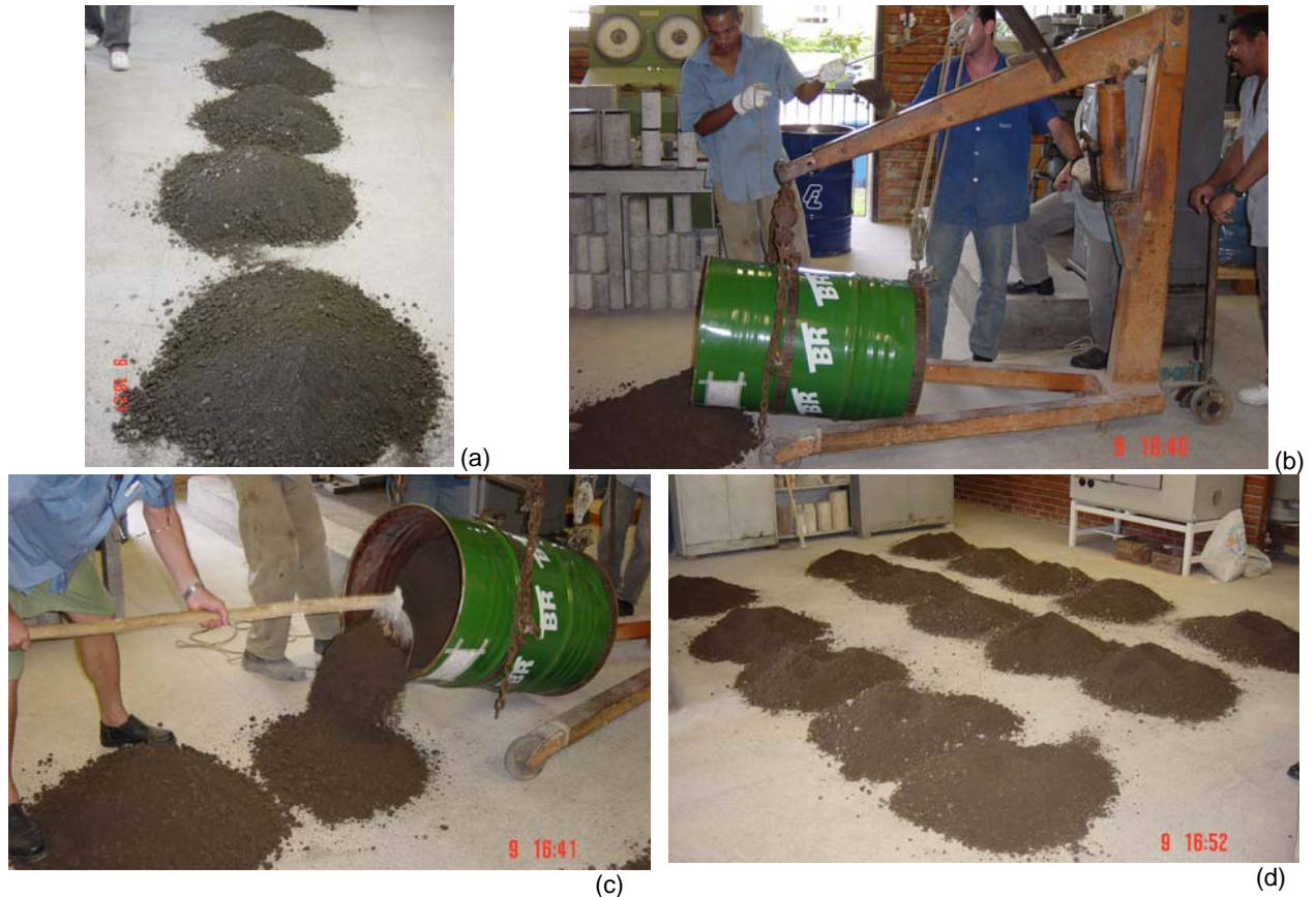
Figura 3.13 - Redução da amostra de campo na UFES: (a) cinco montes de escória de aciaria LD por tonel; (b) retirada da escória do tonel com guincho; (c) retirada da escória com enxada; (d) divisão dos três tonéis em quinze pilhas
