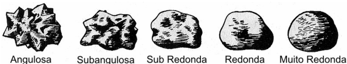
Figura 3.15 - Diferentes níveis de angulosidade das partículas (SOWERS; SOWERS, 1980)
