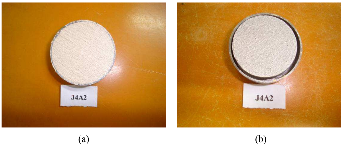
Figura 3.4: Limite de contração antes (material saturado) e depois de seco em estufa e resfriado ao ar
