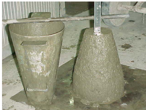
Figura 3.8 – Ensaio de abatimento do tronco de cone
