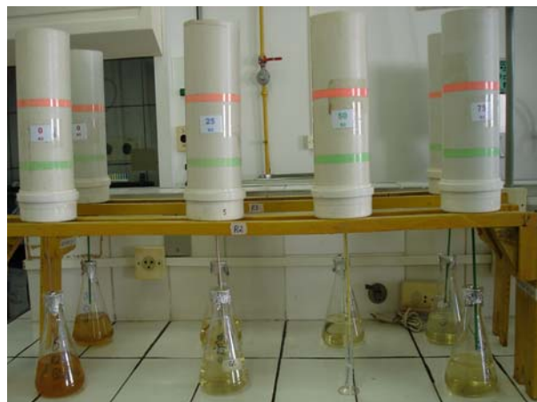
Figura 3.4. Colunas de PVC com amostras do solo natural e com misturas de solo-lodo equivalentes a 25, 50, 75 Mg ha -1 (SILVA, 2007).
