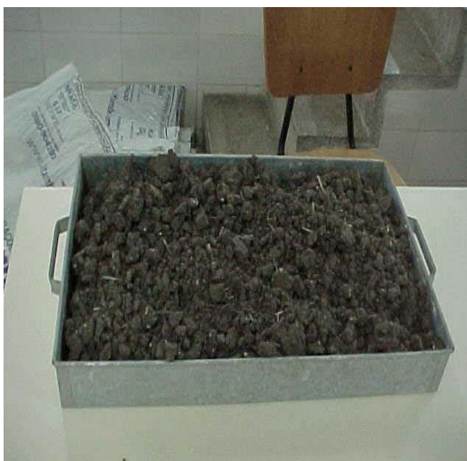
Figura 3.1 - Lodo seco - Estação de Tratamento de Esgoto do Curado.
