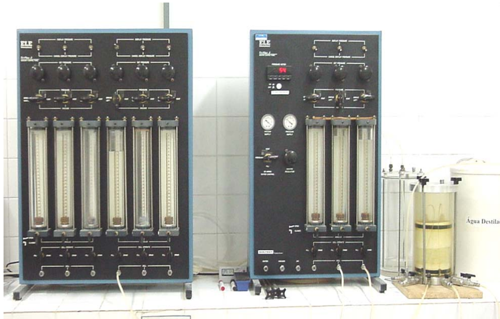
Figura 3.5. Permeâmetro de paredes flexíveis para obtenção da condutividade hidráulica (FERREIRA, 2008)
