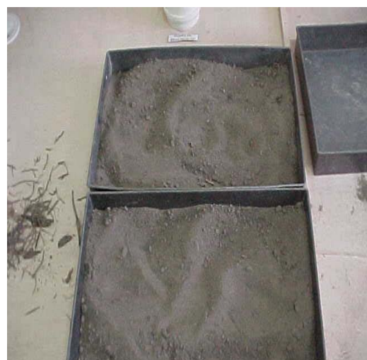
Figura 3.2 - Lodo peneirado- Estação de Tratamento Esgoto do Curado.
