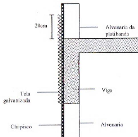
Figura 2.13 – Telamento de encontro alvenaria de platibanda com estrutura – seção transversal (CARVALHO JR., 2005).
