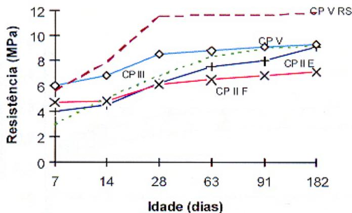
Figura 2.2 - Resistência à compressão das argamassas – NBR – 7215 (CINCOTTO e BOLORINO, 1997)
