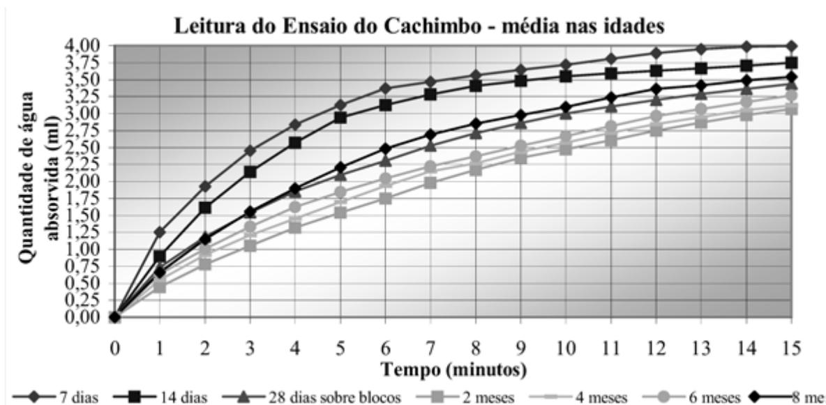
Figura 2.17 - Evolução da permeabilidade do revestimento, nas 7 idades estudadas com ensaios realizados sobre blocos (ALMEIDA e CARASEK, 2003).
