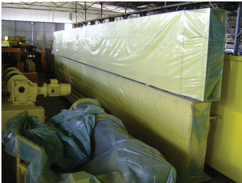
Figura 2.7 – Foto de Ponte Rolante embalada para carregamento.
