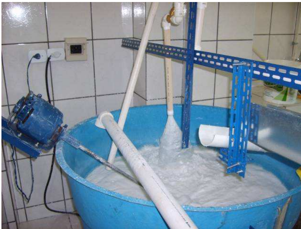
Figura 13: Tanque agitado com suspensão
