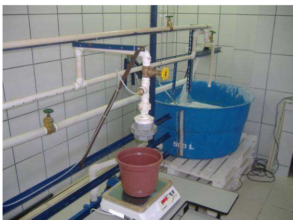
Figura 9: Foto da unidade experimental para a filtração plana sob pressão.
