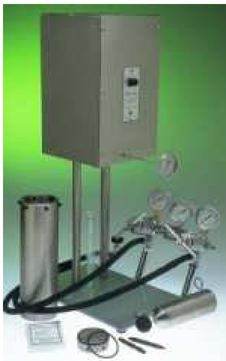
Figura 19: Aparato experimental utilizado para a filtração plana, filtro HTHP.
