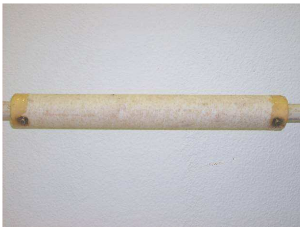
Figura 23: Meio poroso em polipropileno e detalhe da tomada de pressão.
