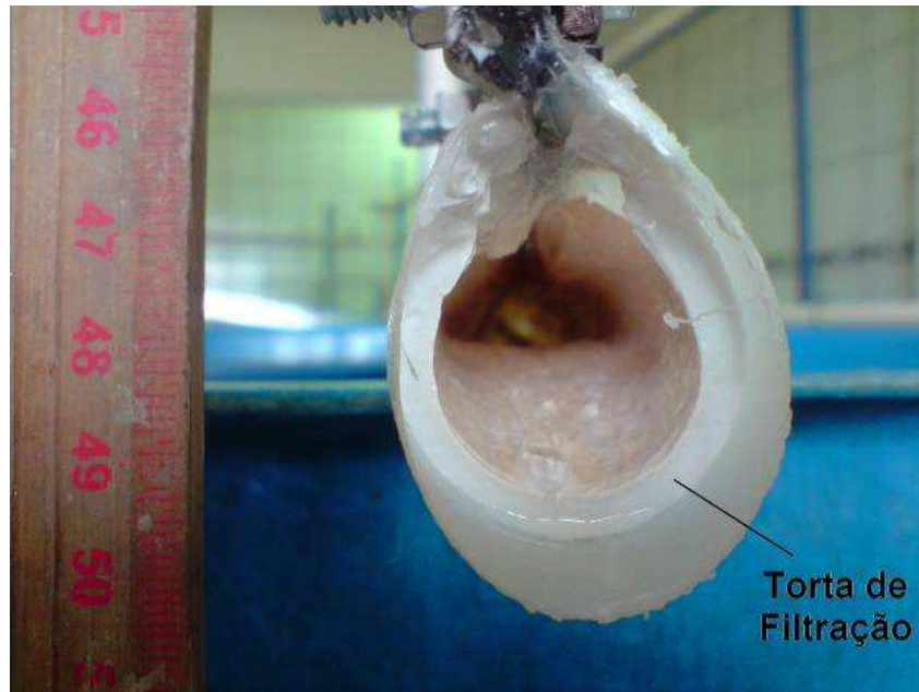
Figura 31: Imagem da torta formada na filtração cruzada a uma pressão de 2 kgf/cm 2 .
