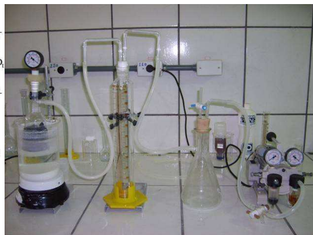
Figura 7: Foto da unidade experimental de filtração plana, filtro folha.
