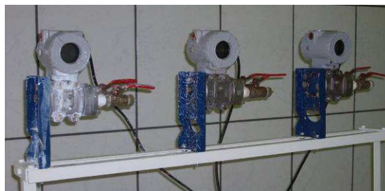
Figura 6: Medidores de pressão diferencial (SMAR).
