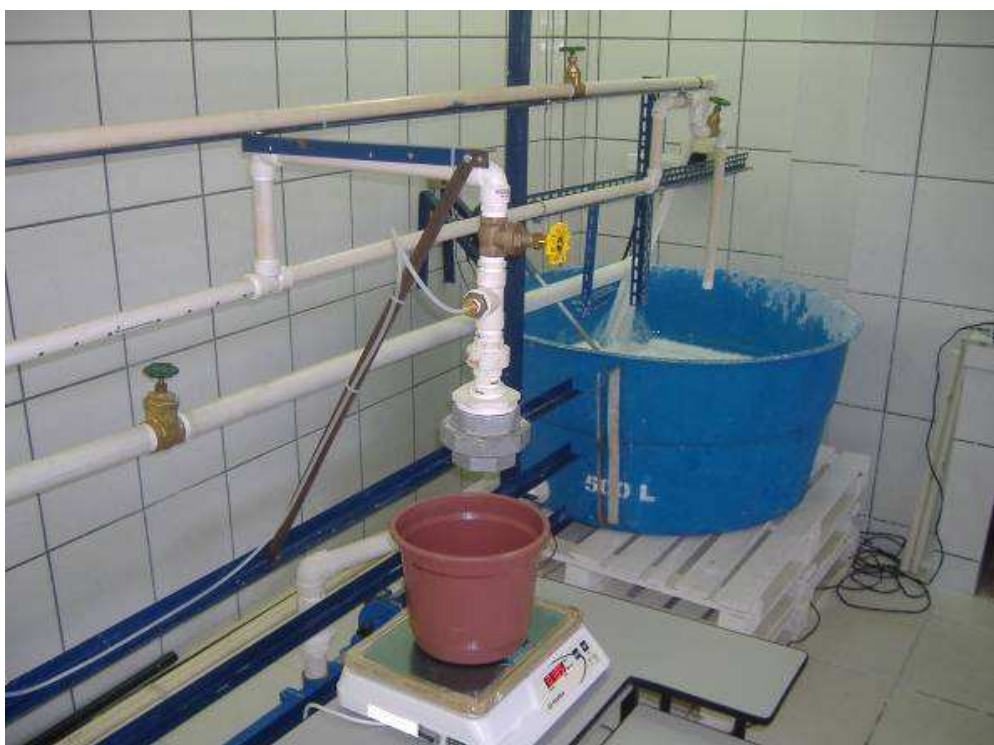
Figura 18: Foto da unidade experimental para a filtração plana sob pressão.
