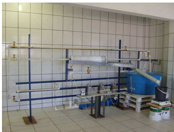
Figura 5: Foto da unidade experimental de filtração cruzada.
