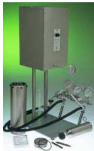
Figura 10: Aparato experimental utilizado para a filtração plana, filtro HTHP.
