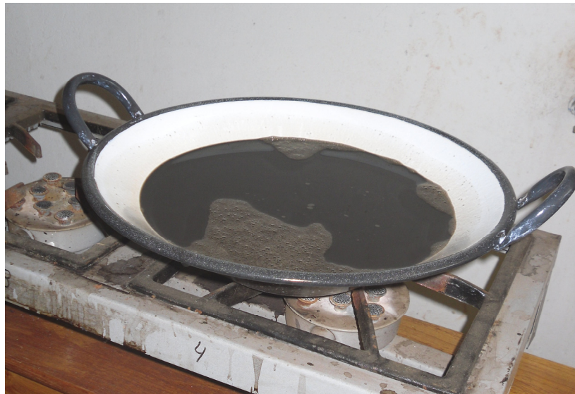
Figura 17- Concentração do resíduo efluente mediante aquecimento para evaporação d'água
