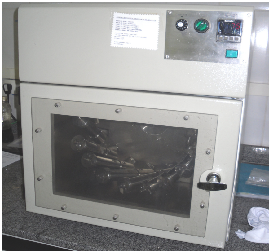
Figura 18 - Equipamento HT utilizado para tingimento
