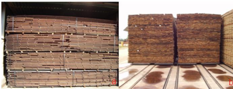
Figura 13 – Madeira preparada para a secagem: (a) carregada por empilhadeiras e (b) por vagonetes
