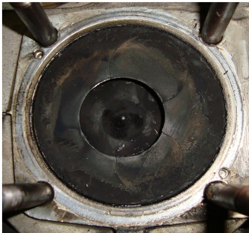
Figura 3.22 Topo do pistão após 150 horas funcionando com a mistura ternária.
