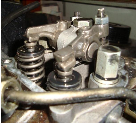
Figura 3.15 Válvulas do motor abastecido com diesel.
