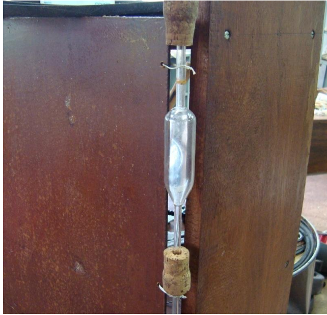
Figura 3.4 Pipeta volumétrica empregada para medição do consumo.
