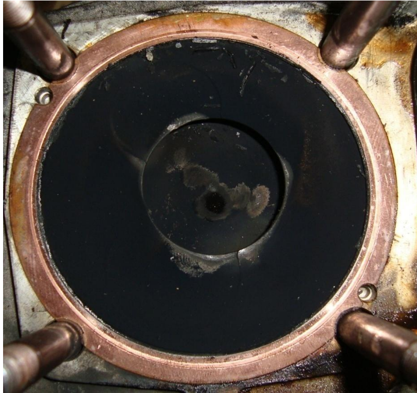
Figura 3.21 Topo do pistão após 150 horas funcionando com óleo diesel.
