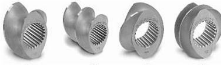
Figura 12– Elementos de condução utilizados em diversas seções da extrusora
