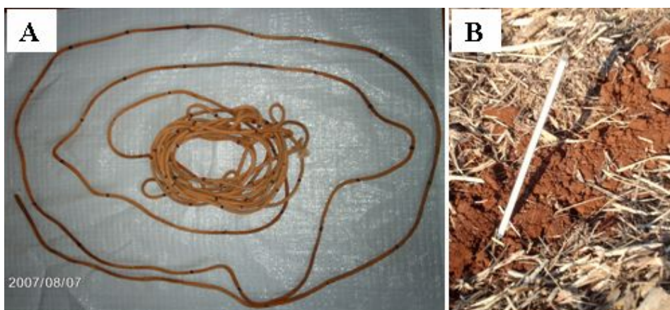
Figura 02 - Vista da trena marcada utilizada para quantificar a porcentagem de palha na superfície da linha de semeadura (A) e do geotermômetro de mercúrio, utilizando no interior do sulco para avaliar a temperatura do solo (B).
