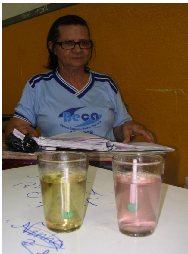
Figura 10: Densímetros imersos em óleo e água, atingindo alturas diferentes
