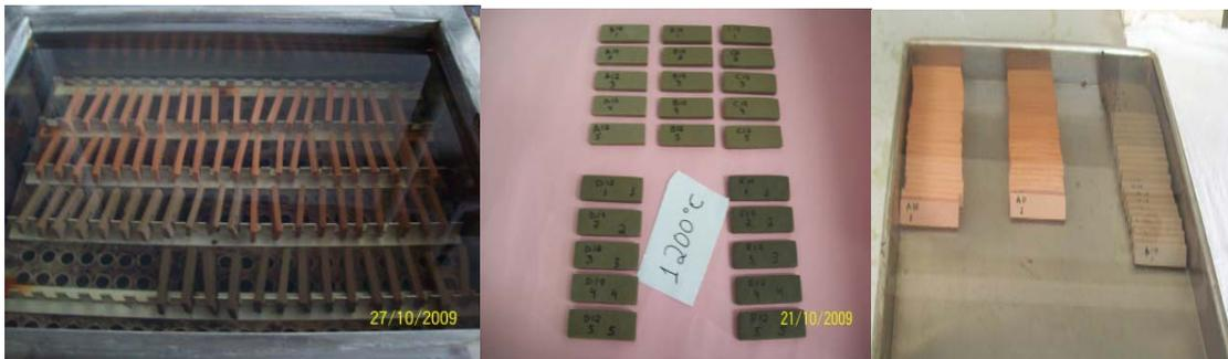
Fig.3.2 – Corpos de provas sinterizados
