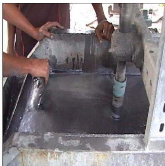
**Figura 2.16 – Flotadeira e retirada do disulfeto
