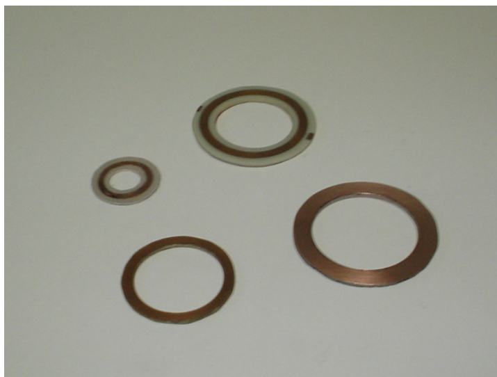
Figura A.8 – Ressonador em anel para microfita do tipo pedestal e truncada.
