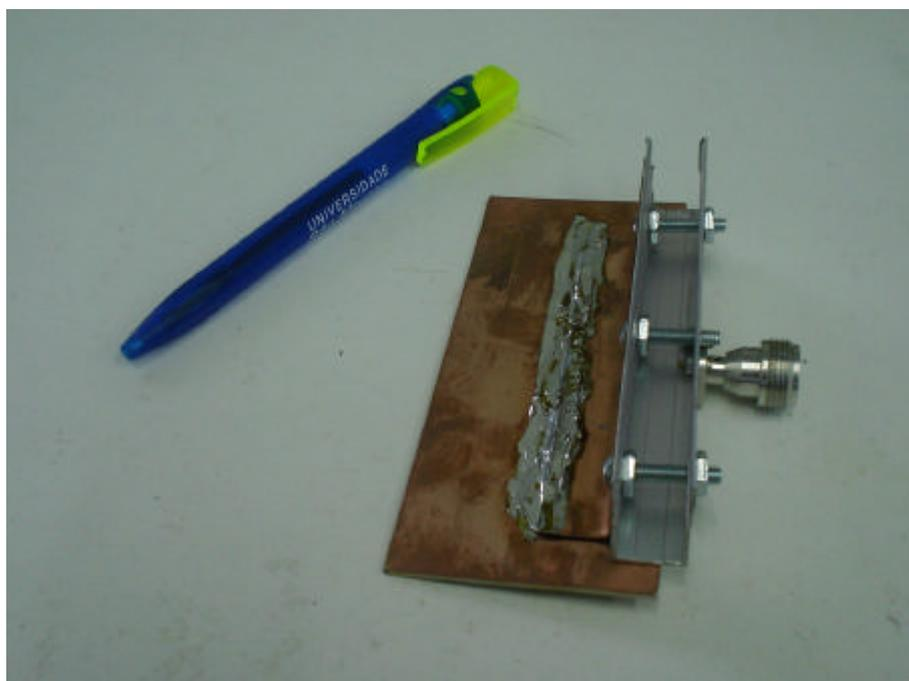
Figura A.4. Detalhe da parte inferior da base de sustentação da antena.
