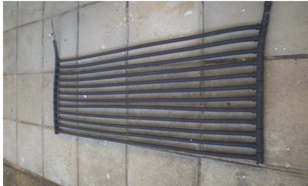
Figura 3.2. Grade absorvedora formada por 12 tubos de PVC de 25 mm.
