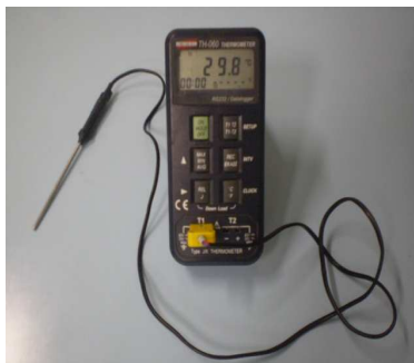
Figura 3.9. O medidor digital de temperatura utilizado nos testes.
