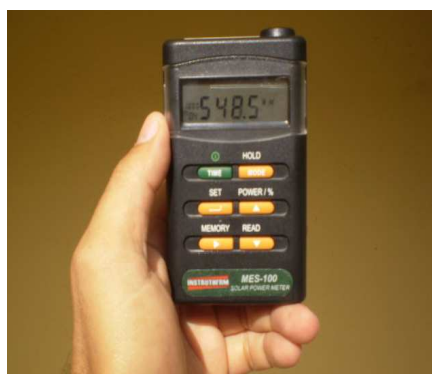
Figura 3.12. O medidor de energia solar digital indicando 548,5 W/ m 2 .
