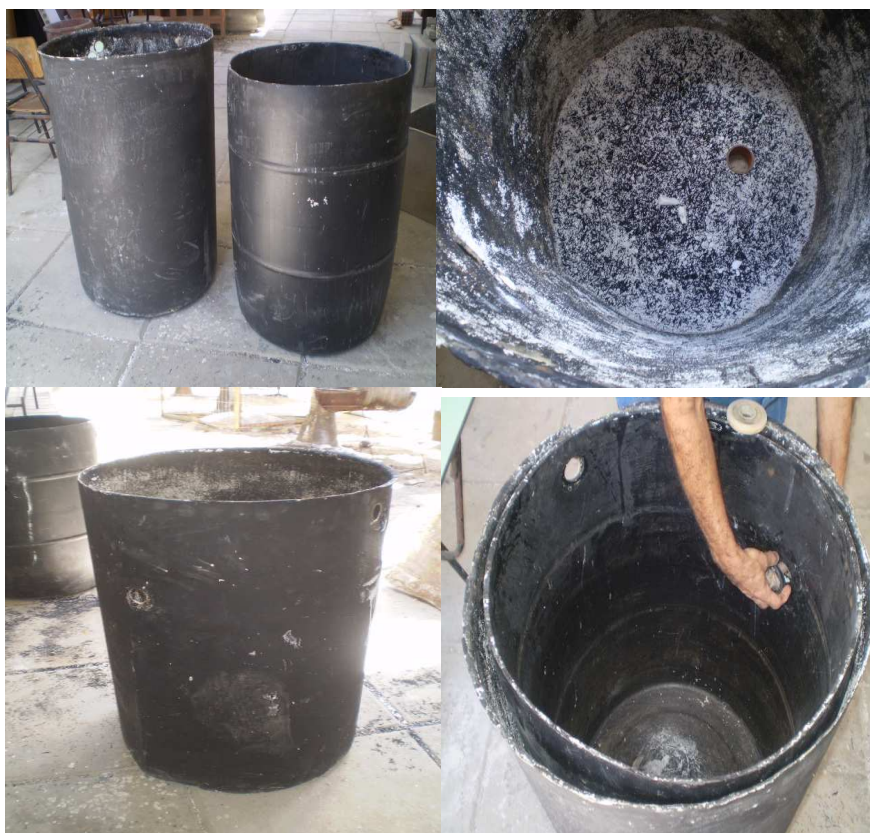
Figura 3.4. O reservatório térmico alternativo RT 200 em reforma.
