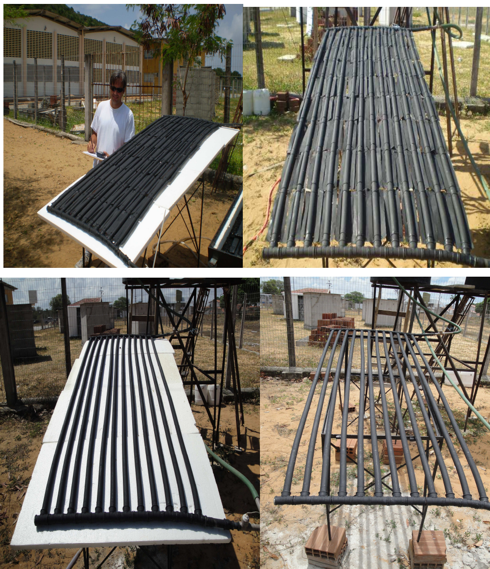
Figura 3.6. Configurações estudadas, no sentido horário, VIII ou VII, VI ou V, IV ou III, II ou I, sem apresentação dos reservatórios térmicos RT 150 e RT 200.
