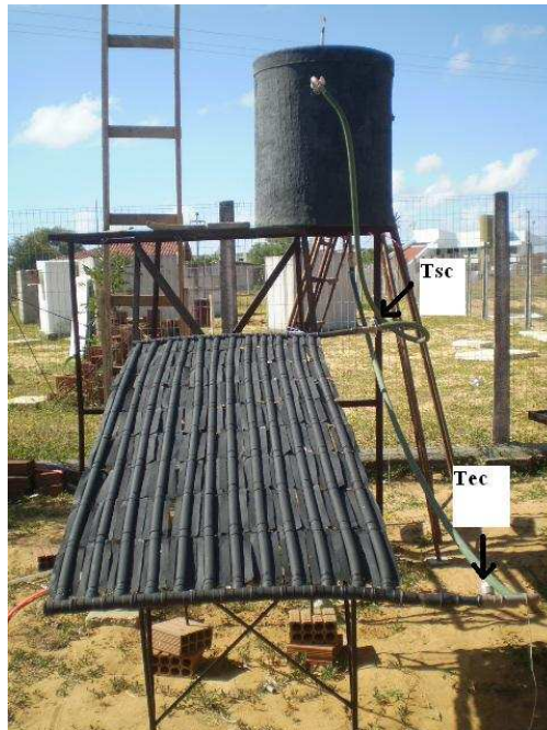
Figura 3.7. Locais de medição da temperatura de entrada (Tec) e saída do coletor (Tsc).
