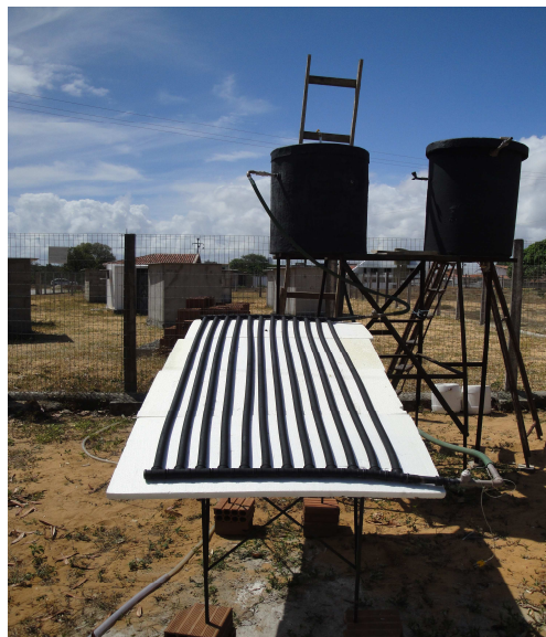
Figura 3.11. Sistema solar alternativo de aquecimento de água em funcionamento na configuração III.
