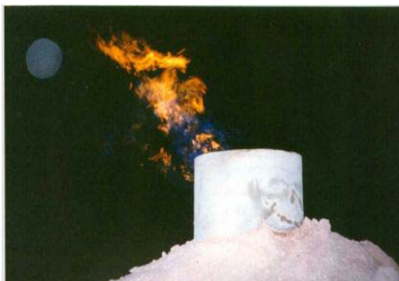
Dreno de gás em combustão, no Aterro da Muribeca 112
