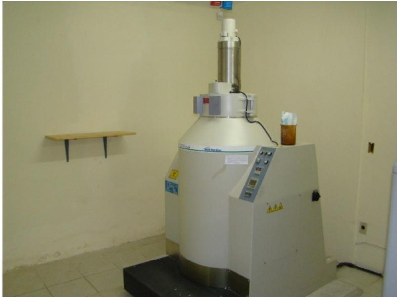
Figura 4: Irradiador Multipropósito emissor de radiação gama (Cobalto-60), utilizado na dose de 30 kGy.
