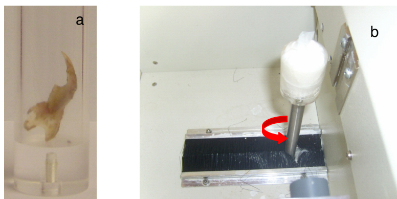
Figura 11. Posicionamento da amostra para escaneamento no equipamento de Micro-CT (a foto mostra uma mandíbula). a) Posicionamento da mandíbula no interior do recipiente em acrílico, b) Amostra posicionada na plataforma giratória dentro do equipamento de Micro-CT.
