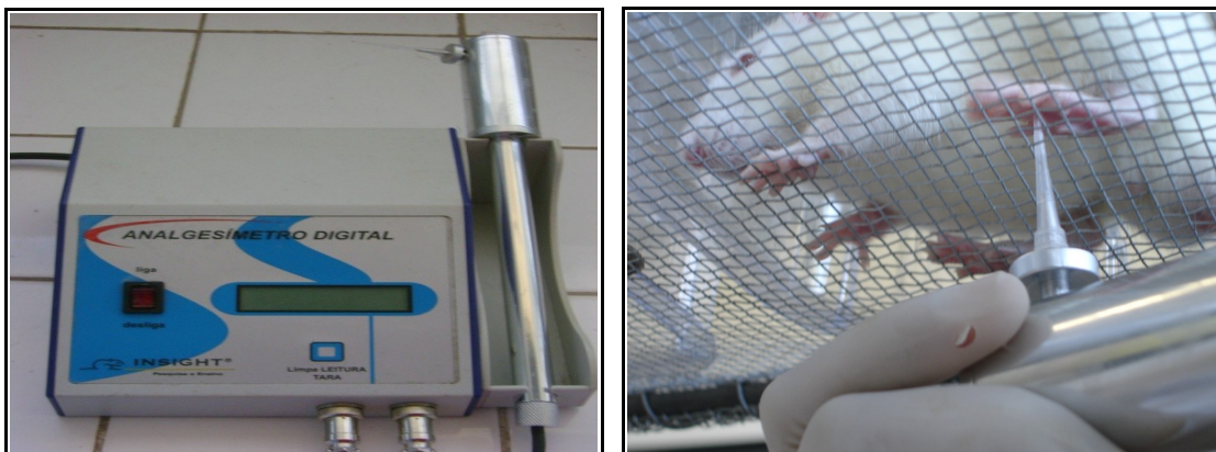
Figura 5 - Teste de estimulação tátil (von Frey). A figura a esquerda mostra o analgesímetro eletrônico von Frey. A figura a direita mostra o momento em que a ponta de polipropileno é colocada perpendicularmente à área central da pata posterior do animal com aumento gradual de pressão, a fim de eliciar um reflexo de flexão seguido de um movimento de retirada.
