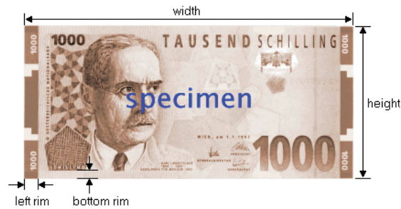
Figura 4.24: Exemplo das medidas extraídas de notas utilizadas como conjunto de teste
