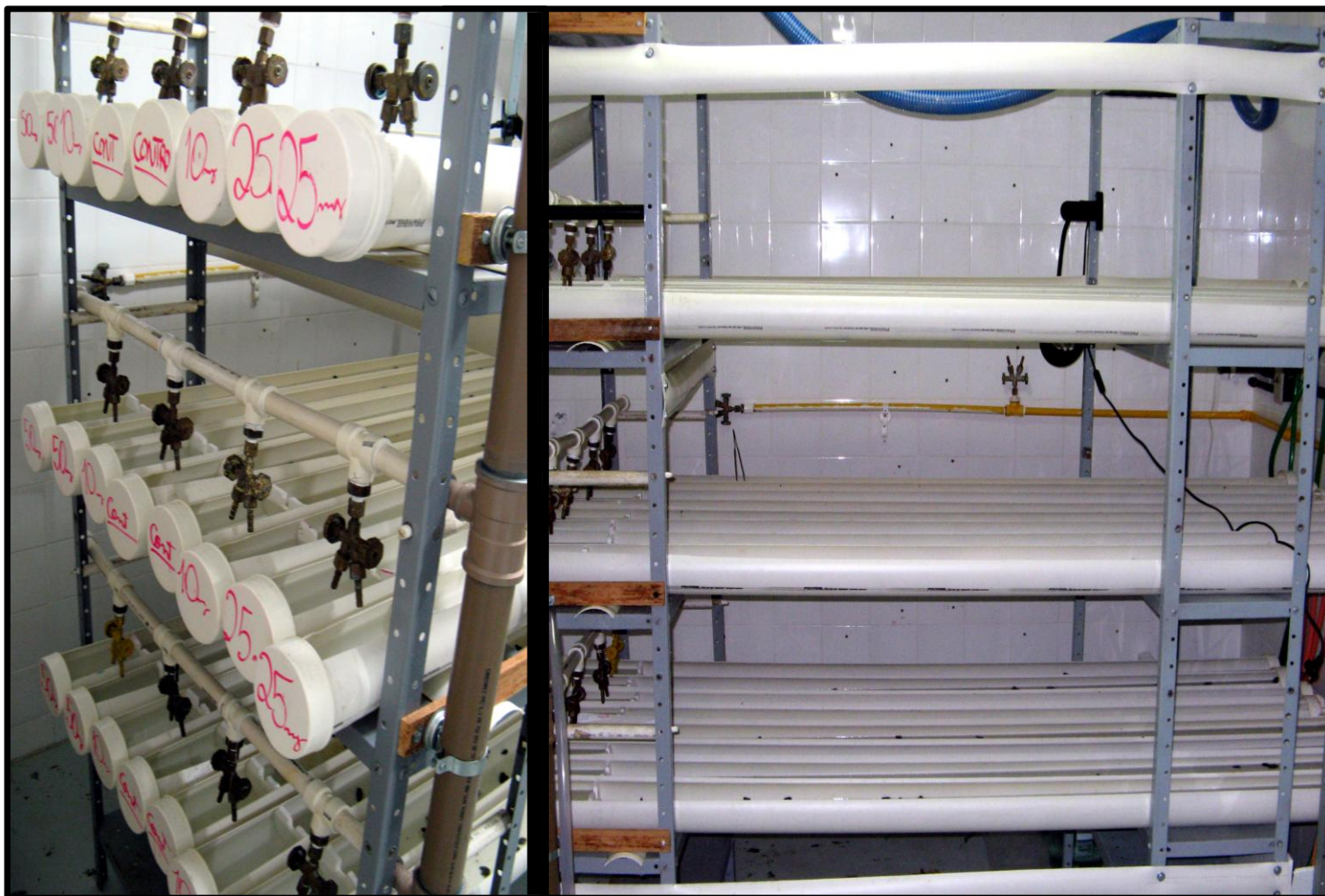
FIGURA 10 - Sistema de calhas com fluxo contínuo unidirecional sem o reuso da água.
