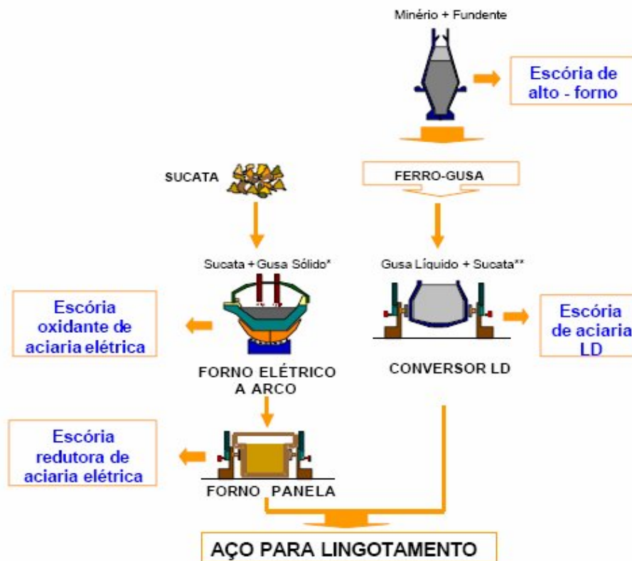
Figura 2.1 - Representação esquemática da produção do ferro-gusa e processos de refino do aço, com suas respectivas etapas de geração de escórias (MASUERO, 2001)
