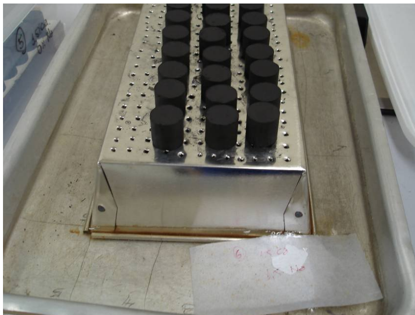
Figura 3.2 - Corpos-de-prova sendo preparados para ativação térmica
