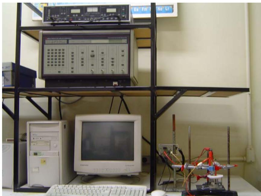
Figura 3.5 – Fotografia do conjunto de equipamentos utilizados nos ensaios eletroquímicos: Potenciostato/Galvanostato; computador dedicado ao sistema e célula eletroquímica.
