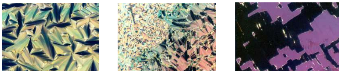
Figura 2.8: a) Textura de SmA cônico focal, b) SmC apresentando texturas de Schlieren e focal cônico, c) Textura SmC^* (CL ferroelétrico) [72].
