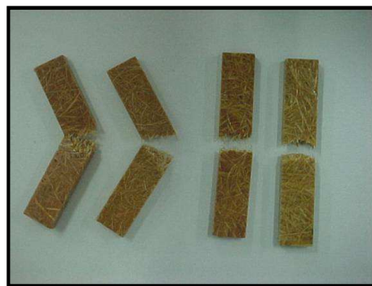
Figura 54: Foto das amostras após de compósitos reforçados com fibras de sisal de comprimento 3cm.
