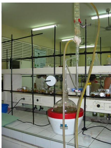
Figura 5. Aparelho usado para extração do óleo essencial por hidrodestilação.
