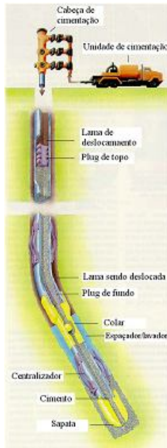
Figura 5 - Esquema mostrando uma operação de cimentação de poço de petróleo e alguns equipamentos acessórios
