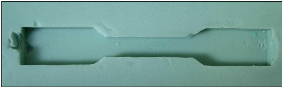
Figura 33 – Molde do corpo de prova em silicone de condensação
