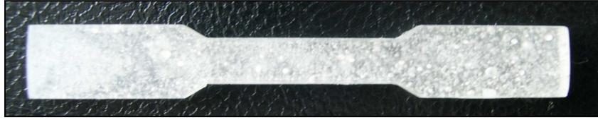
Figura 32 – Corpo de prova (mestre) em resina acrílica.
