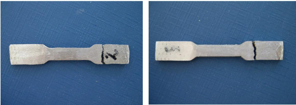
Fig. 38 e 39 – Corpos de prova com fraturas fora da área útil.
