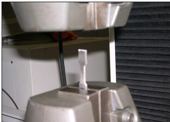
Figura 37 - Corpo de prova posicionado para ensaio.
