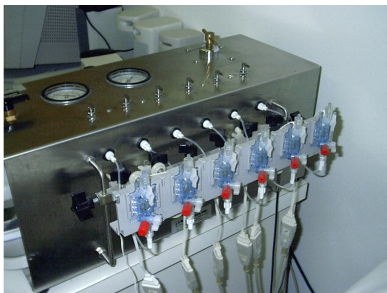
Figura 15a – Bomba de infusão pneumo-hidráulica com nitrogênio de alta pureza da marca J.S.Biomedical, INC® Fonte: Imagem obtida por fotografia no laboratório do SEFIDI.
