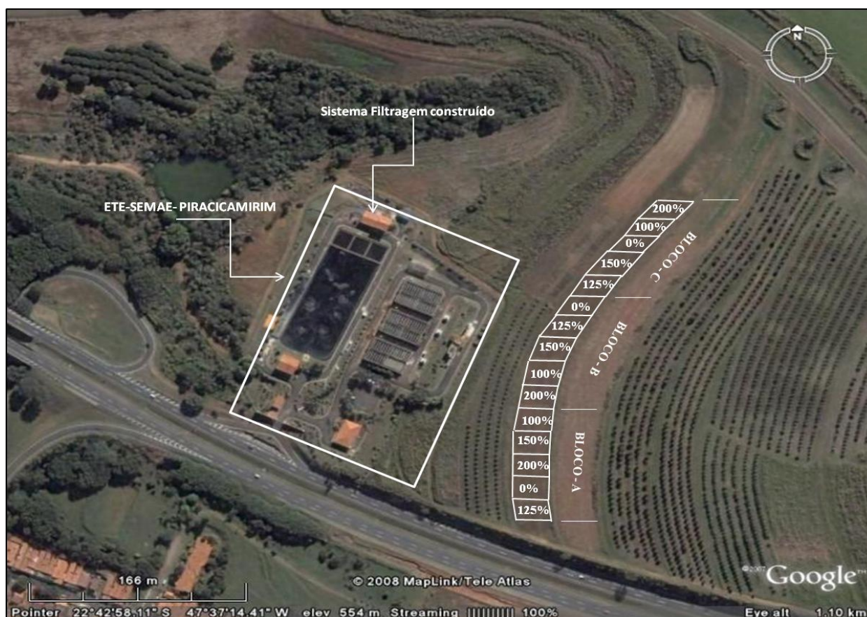
Figura 3.1 - Estação de tratamento de esgoto (SEMAE-Piracicamirim) e área experimental no campus Esalq-USP, Piracicaba-SP. Tratamentos: 100, 125, 150 e 200% da lâmina de irrigação fornecida com base na evapotranspiração da cultura, e 0% (sem irrigação)
