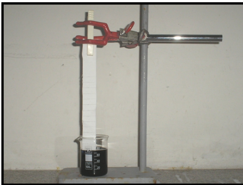
Figura 3.7 – Aparato experimental utilizado para análises de hidrofiliidade (Arraste Vertical).
