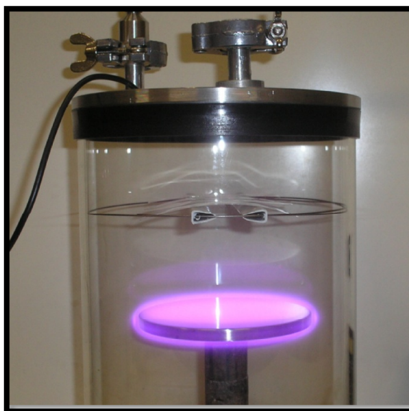
Figura 3.3 – Foto ilustrativa da posição dos filmes de poliéster na câmara durante o tratamento por plasma.
