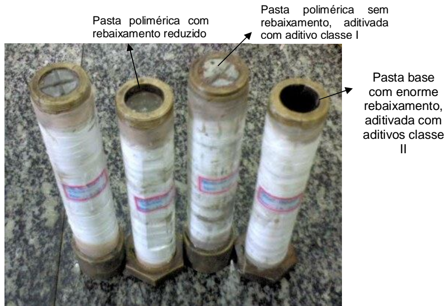
Figura 4.32: Pastas poliméricas com aditivos classe I e aditivos classe II
