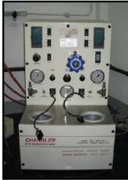
Figura 3.10: Equipamento analisador ultrassônico de cimento (UCA)
