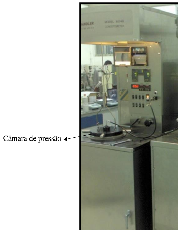
Figura 3.7: Consistômetro pressurizado Chandler modelo 7716
