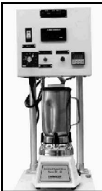
Figura 3.3: misturador de palheta da Chandler modelo 80-60
