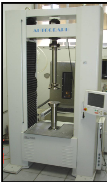
Figura 3.11: Máquina de ensaios mecânicos Shimadzu Autograph Modelo AG-I
