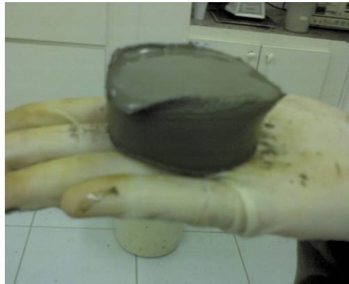
Figura 4.30: Filtrado com formação de reboco
