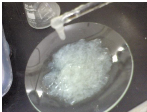
Figura 4.8: Interação quitosana e aditivo à base de silicone
