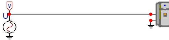
Figura 2.13 – Componente representativo do refrigerador doméstico para o ATP – 2 pinos
