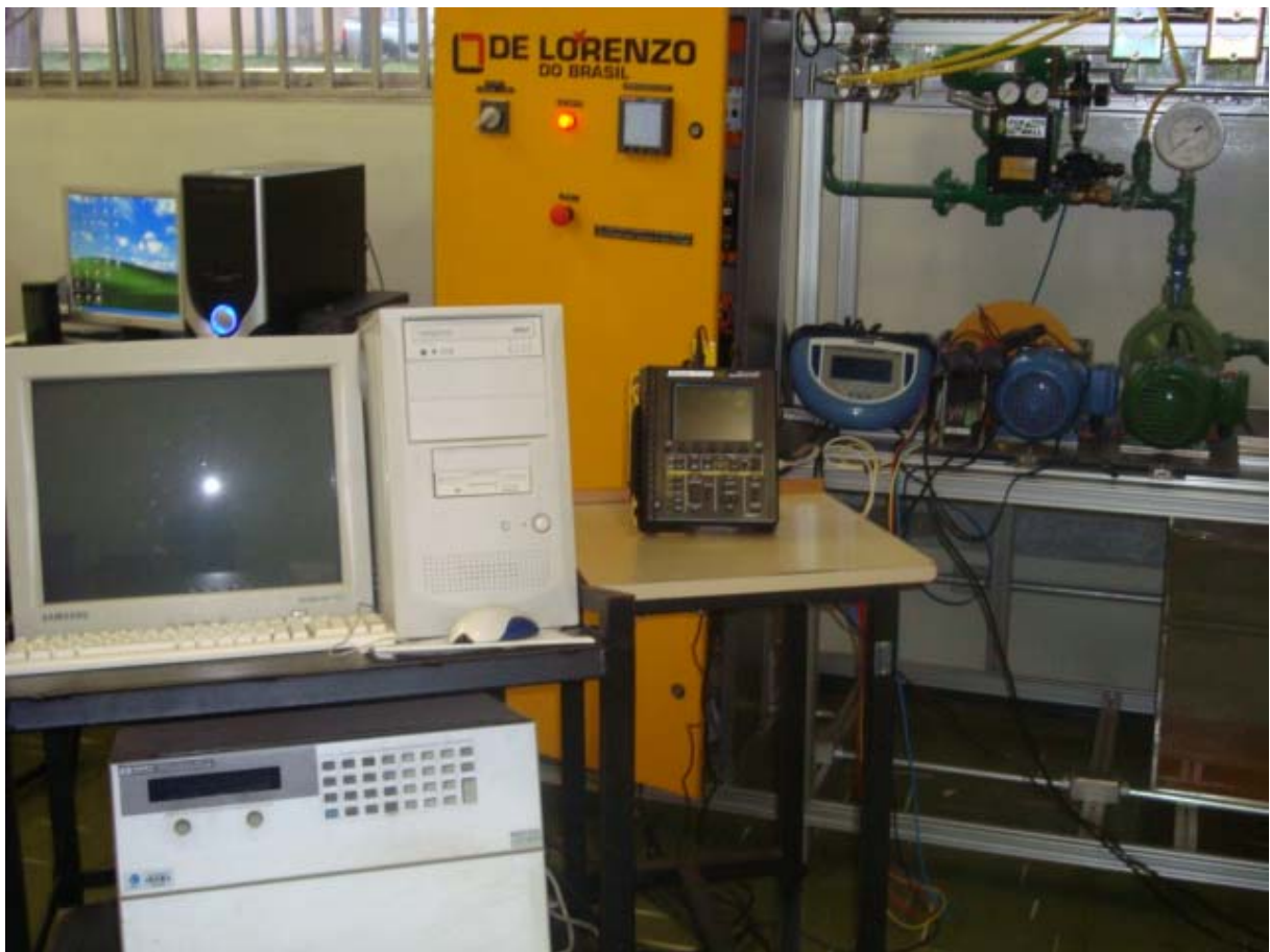
Figura 3.13 – Visão geral da bancada da bomba centrífuga, fonte e equipamentos de medições.
