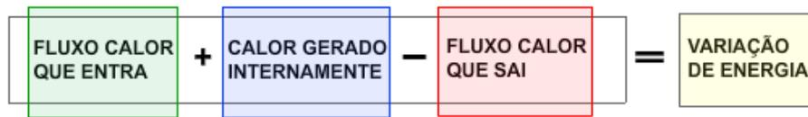
Figura 3.3-Equação de difusão de calor
