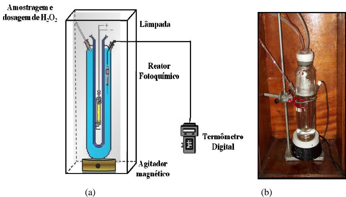
Figura 4.6. Reator lâmpada anular de fluxo ascendente: (a) Esquema ilustrativo e (b) Foto.
