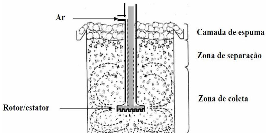
Figura 2.9. Esquema de uma célula de flotação.
