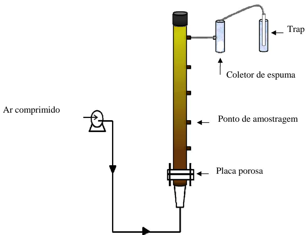
Figura 4.3. Esquema do sistema de flotação em coluna utilizado.
