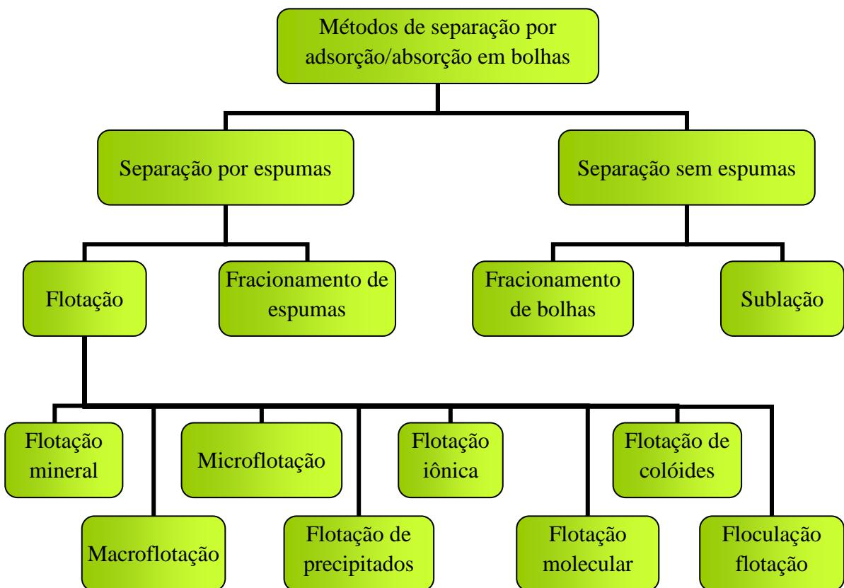
Figura 2.7. Esquema das técnicas de separação por adsorção em bolhas de ar.
