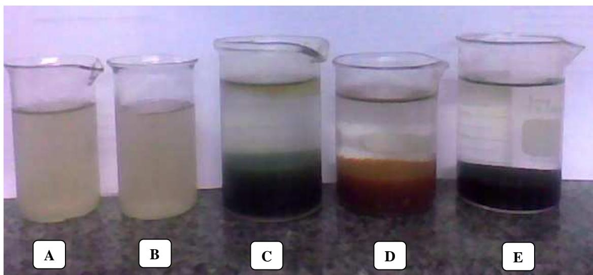
Figura 5.2. Remoção do ferro da água de produção sintética por precipitação química. (a) água de produção +  $\text{NaCl}$ ; (b) água de produção +  $\text{NaCl} + \text{CaCl}_2$ ; (c) água de produção +  $\text{NaCl} + \text{CaCl}_2 + \text{FeSO}_4$ ; (d) água de produção +  $\text{NaCl} + \text{CaCl}_2 + \text{Fe}_2(\text{SO}_4)_3$ ; (e) água de produção +  $\text{NaCl} + \text{CaCl}_2 + \text{FeSO}_4 + \text{Fe}_2(\text{SO}_4)_3$ .
