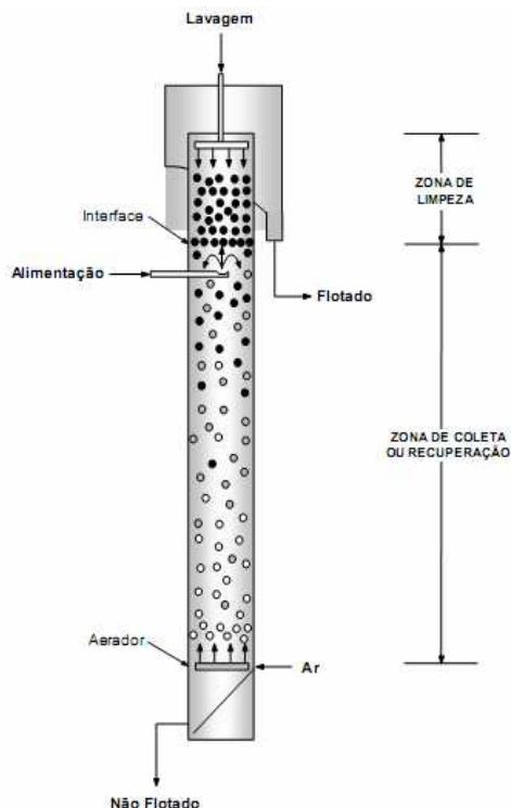
Figura 2.8. Esquema de uma coluna de flotação.
