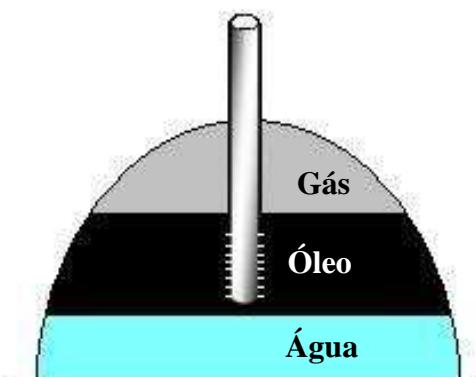
Figura 2.1. Esquema de um reservatório de óleo com capa de gás.
