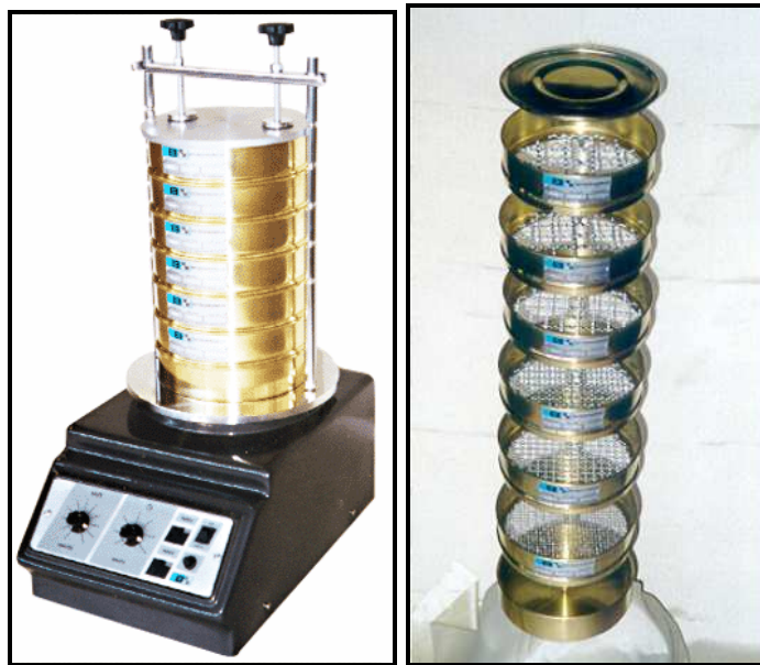
Figura 4.3 – Agitador e conjunto de peneiras da série Tyler.
