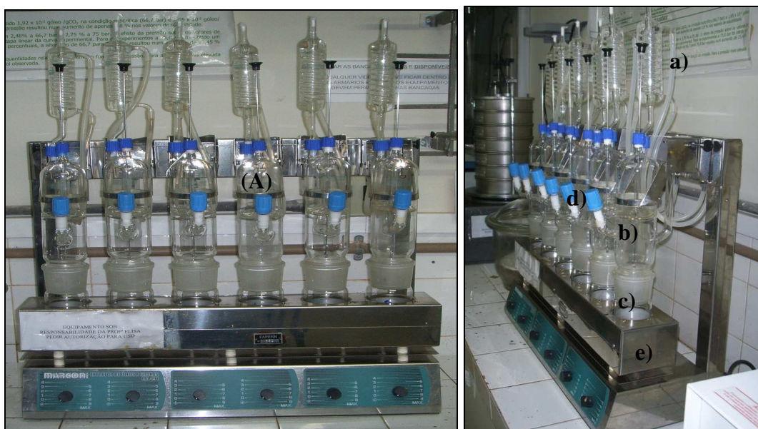
Figura 4.5 – Extrator de óleos e gorduras (MARCONI - MA-491) ( a) condensador, b) câmara de extração, c) becker para o solvente de extração, d) válvula de controle de fluxo do solvente condensado, e) base aquecedora)
