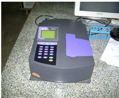
Figura 4.4: Espectrofotômetro Biochrom, modelo Libra S12
