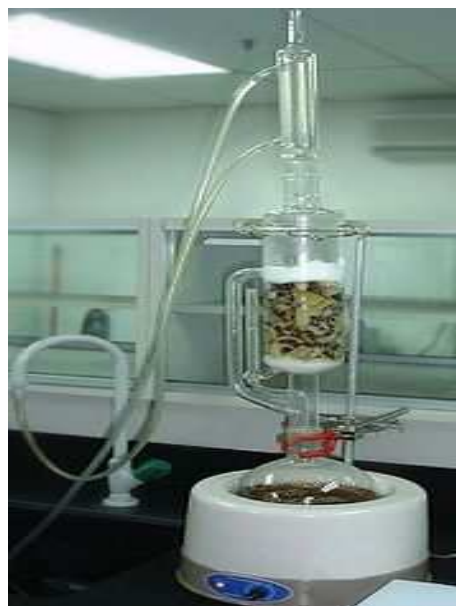
Figura 4.1: Ilustração do Soxhlet em operação .
