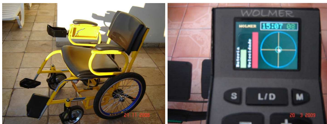
Figura 8.1: Cadeira de rodas que será controlada através de sinais eletromiográficos e Visor do sistema de controle.
