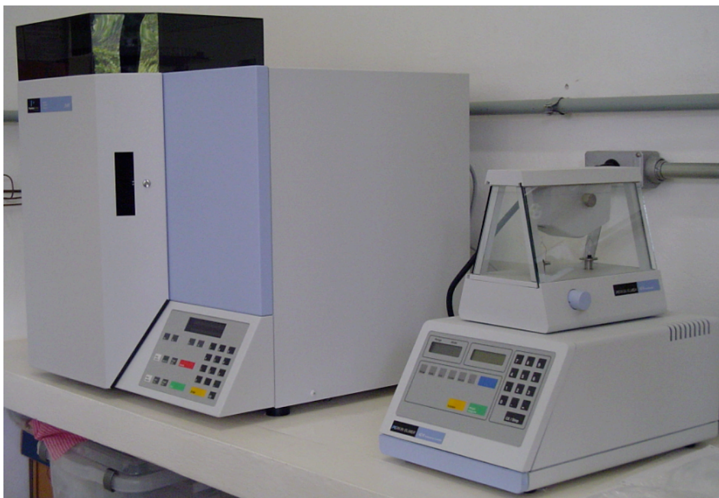
Figura 13 – Analisador CHNS Perkin Elmer 2400 Série II
