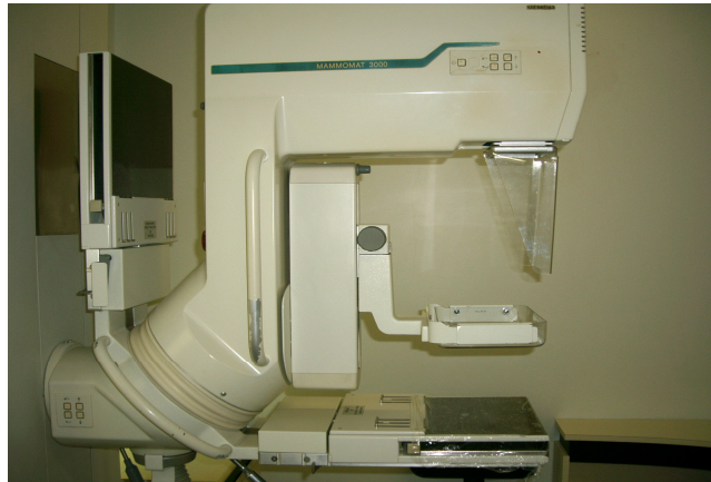
Figura 7. Equipamento mamográfico Mamomat 3000 (Siemens®) disponibilizado pelo setor de mamografia do Hospital São Lucas da PUCRS, para a obtenção das radiografias do fêmur dos ratos.
