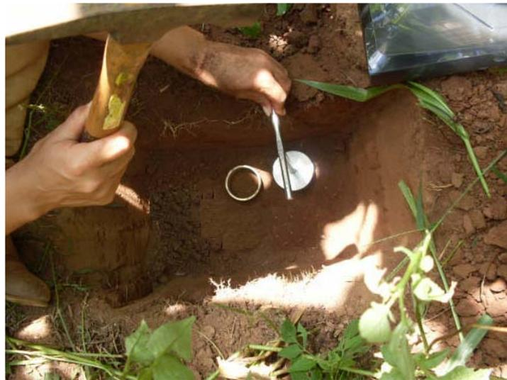
**Figura 2.** Coleta de amostras indeformadas de solo para as análises físicas.
