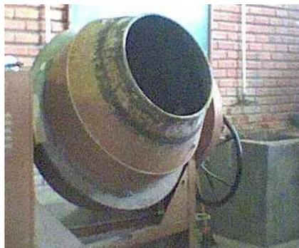
**Figura 4. 10: Betoneira de tambor inclinado basculante.**
