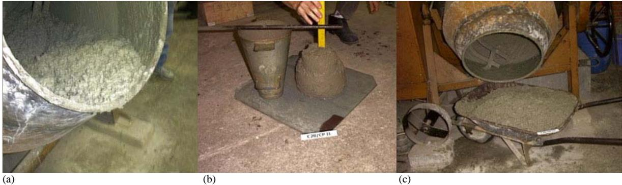
**Figura 4.11: Seqüência de mistura e moldagem dos corpos-de-prova: a) mistura; b) abatimento; c) descarga e transporte.**
