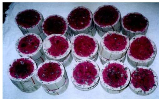
Figura 5. 16: Carbonatação natural C30: aos 365 dias.
