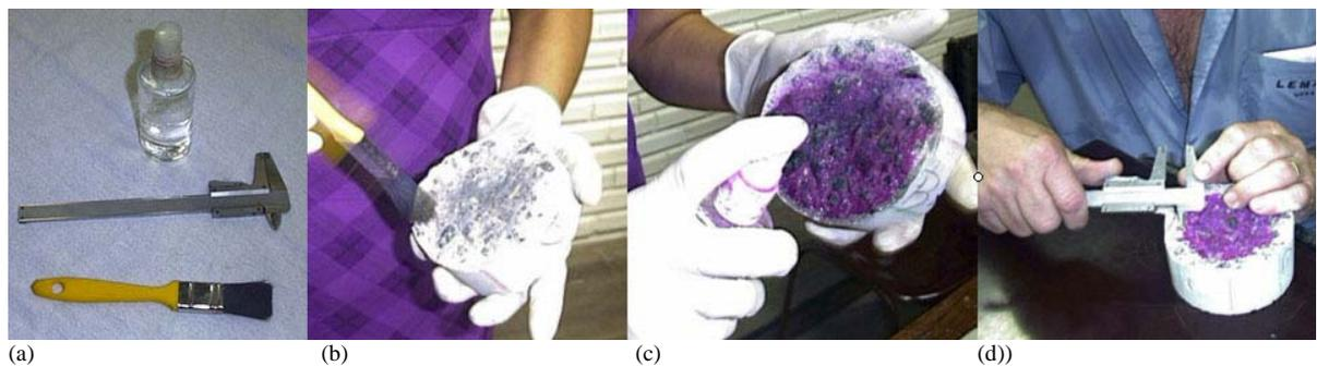
**Figura 4.14: Seqüência do ensaio de carbonatação; (a) ferramentas; (b) limpeza da seção; (c) aspersão de fenolftaleína e (d) medida da profundidade de carbonatação.**
