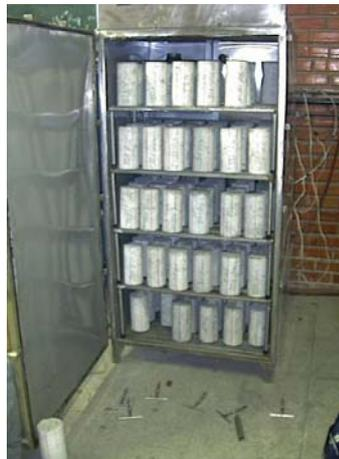
Figura 4. 15: Câmara de carbonatação.
