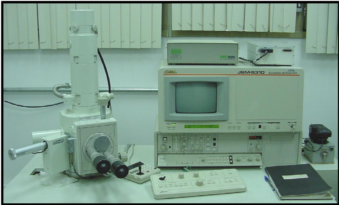
Figura 6 – Microscópio Eletrônico de Varredura – Jeol – JSM 5310
