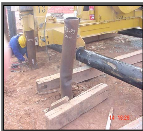
Figura 4.9 Flambagem local do trecho livre da estaca E07
