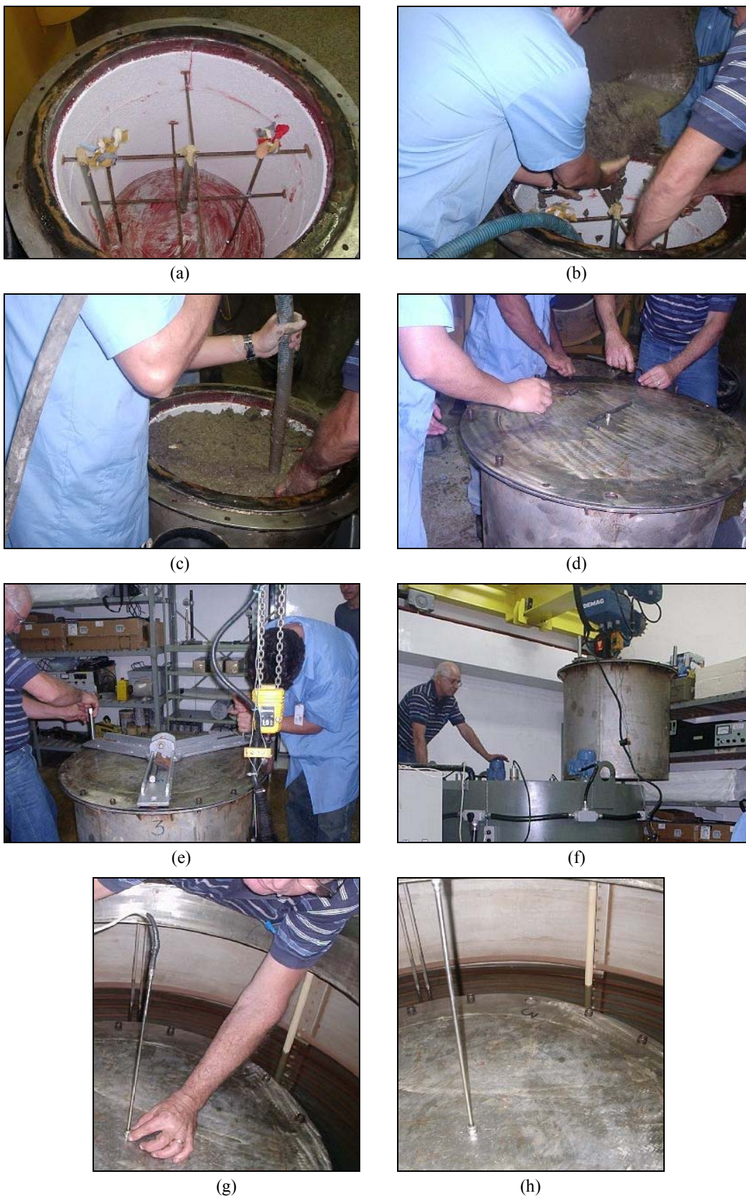
Figura 3-13 – Moldagem do corpo de prova e preparação do calorímetro
