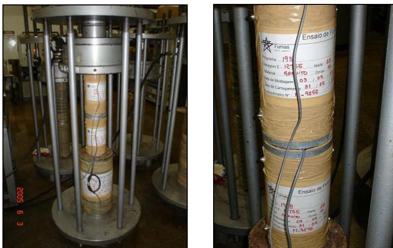
Figura 3-17 – Ensaio de fluência de duas misturas de CAD
