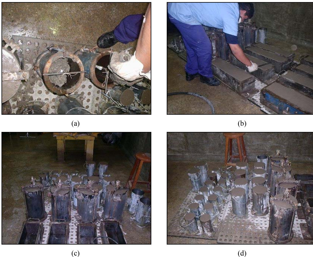
Figura 3-10 – Moldagem dos corpos de prova
