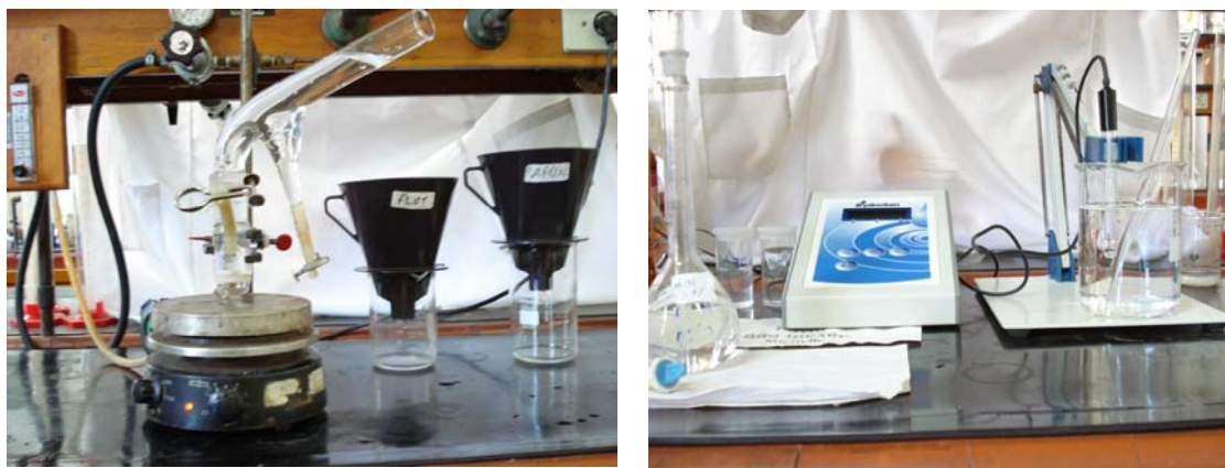
Figura 4.2 – Unidade experimental: a) tubo de Hallimond modificado; b) ajuste do pH antes do teste de microflotação.
